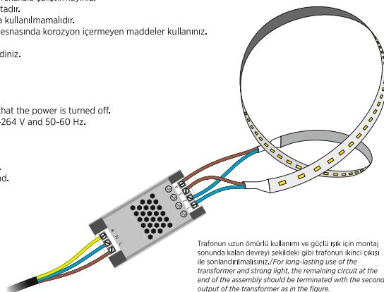
Trafonun uzun ömürlü kullanımı ve şöglü işk için montaj sonunda kalan devreyi şekildeki gibi trafonun ikinci çıkış ile sonlandırılmışsınz. For long-lasting use of the transformer and strong light, the remaining circuit at the end of the assembly should be terminated with the second output of the transformer as in the figure.
